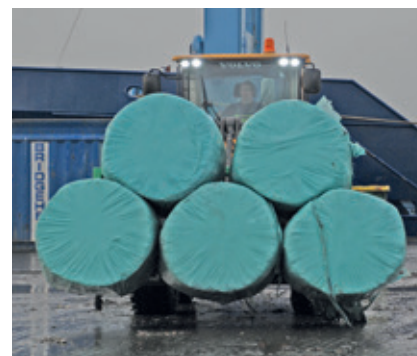
◀ En ny Volvo L90G tager fem pakker affald ad gangen på den specielle fork, der er fremstillet til formålet.
