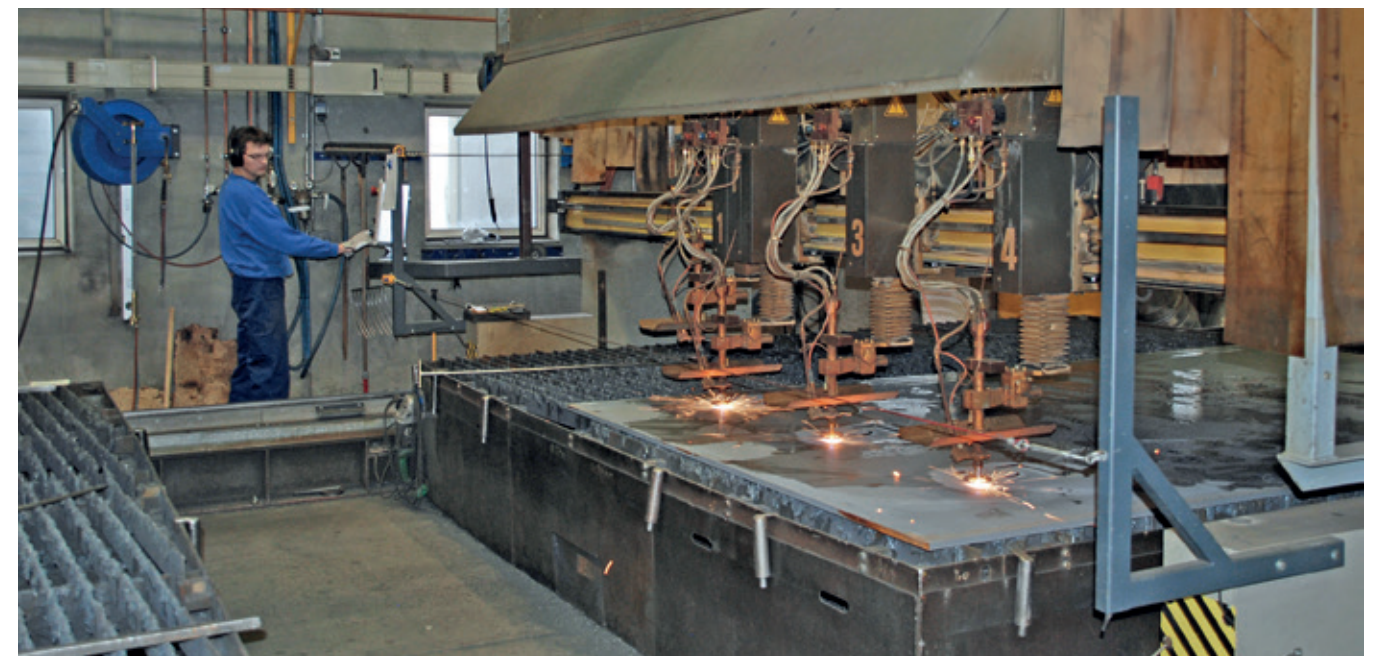
▲ Læserskæring i de kraftige stålplader sikrer optimal udnyttelse af materialerne.
