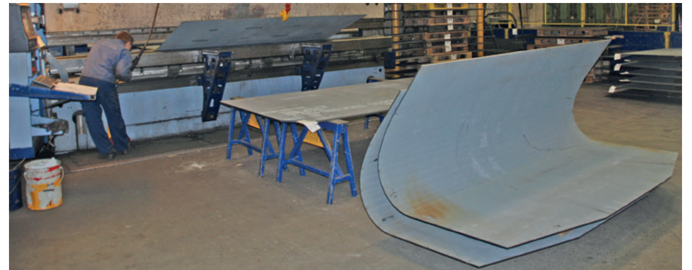
▲ Der begynder at tegne sig et billede af en læsseskovl, når pladen er bukket. Sjørring Maskinfabrik producerede i 2014 ca. 3000 originale Volvo læsseskovle.
